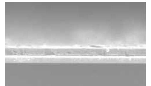
圖四、電鍍鈦複合膜側面電子顯微鏡圖
